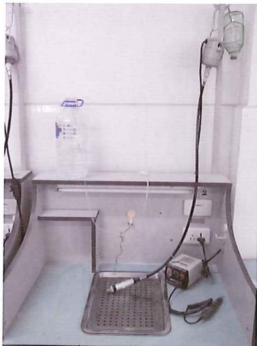
图5-14 蛇皮钻（吊机）
