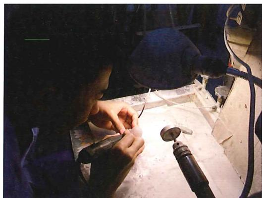
图5-35 琢磨玉器（细部修整）
