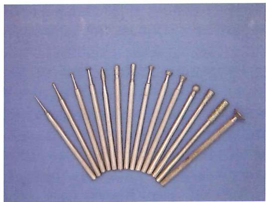
图5-23 常用小型钻石粉工具
